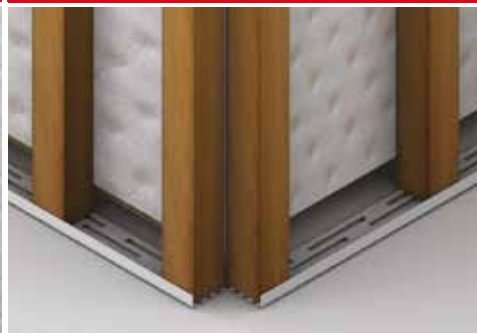
5. Монтаж перфорированного вентиляционного профиля.
