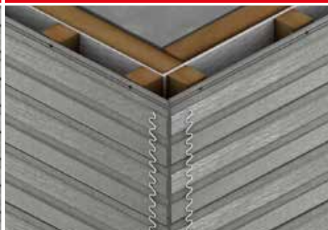
8. Заполнение зазоров и примыканий герметиком у внешнего, и внутреннего угла.
